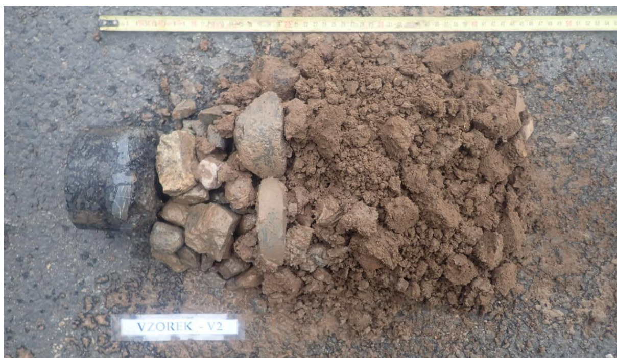
Obr. 3 - Jádro vývrtu Vzorek – V2 (in situ).
