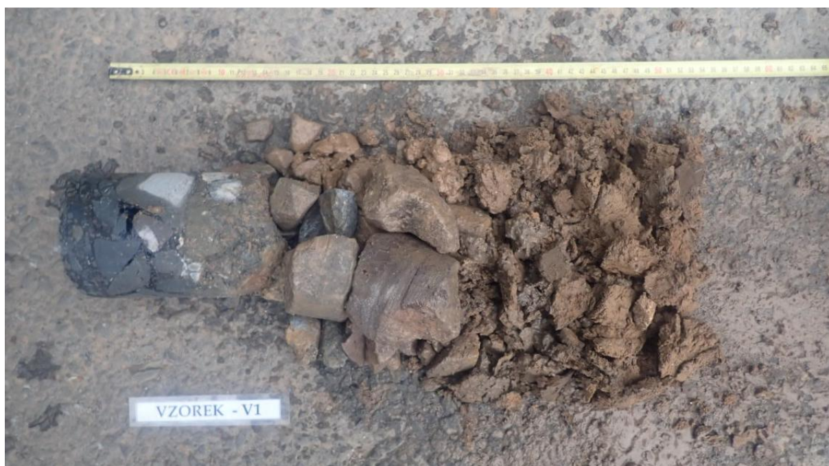
Obr. 1 - Jádro vývrtu Vzorek – V1 (in situ).
