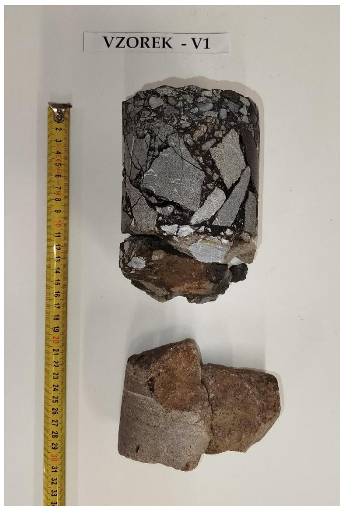
Obr. 2 - Jádru vývrtu Vzorek – V1 (laboratoř).
