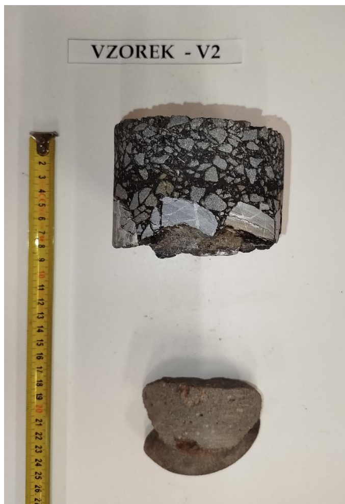
Obr. 4 - Jádru vývrtu Vzorek – V2 (laboratoř).
